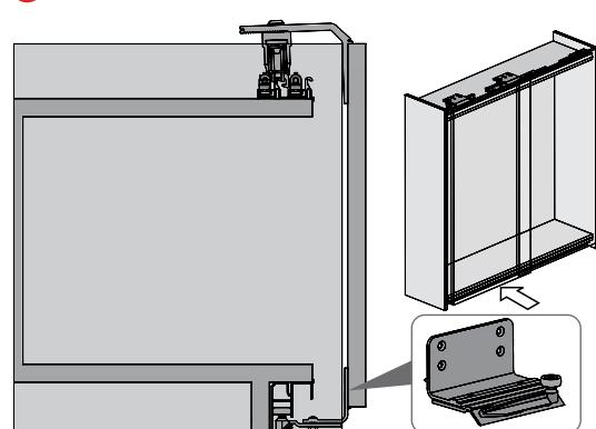
Вставьте ролик в направляющую и защелкните его, надавив на нижнюю часть двери
