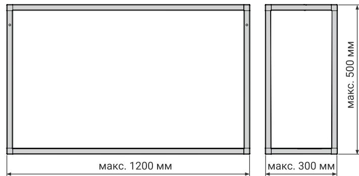
Максимальная нагрузка на 1 полку – 50 кг на 1 кв.м.
