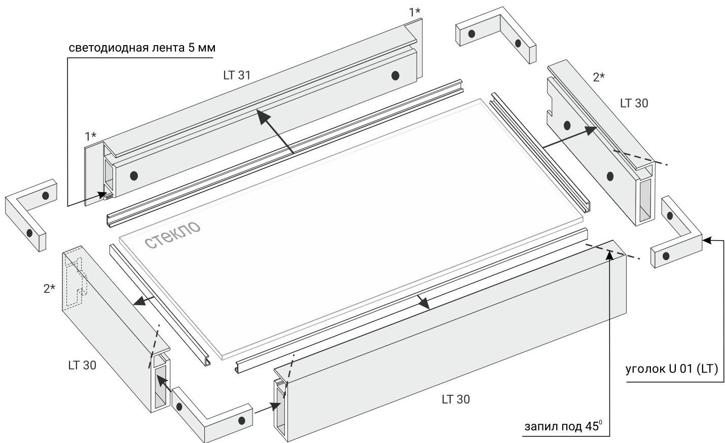
Схема присадки и фрезеровки углового соединения LT 30 и LT 31
