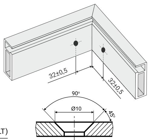
Схема сборки световой полки на базе профилей LT 30 совместно с LT 31
