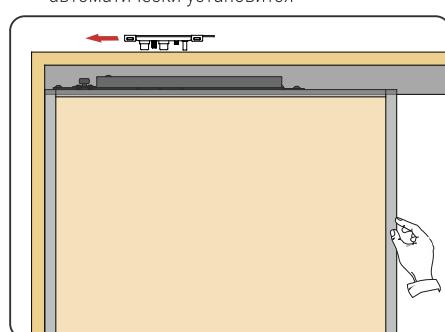
14 Откройте дверь, зафиксируйте улавливатель
