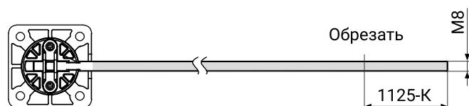
Обрезка длины шпильки (обрезка обязательна для верхней и нижней частей)
