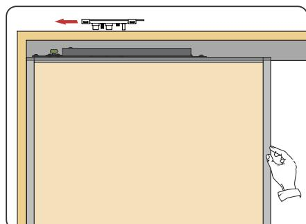
2 Откройте дверь, зафиксируйте улавливатель
