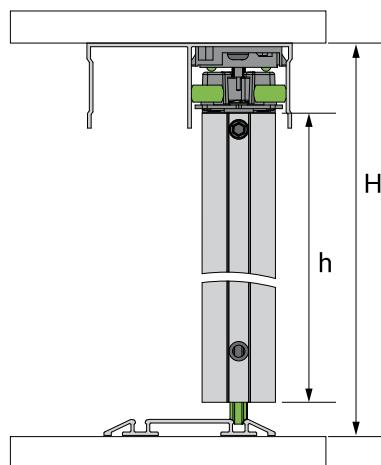
$$h \text{ (высота двери)} = H \text{ (высота проёма)} - 40 \text{ мм}$$
