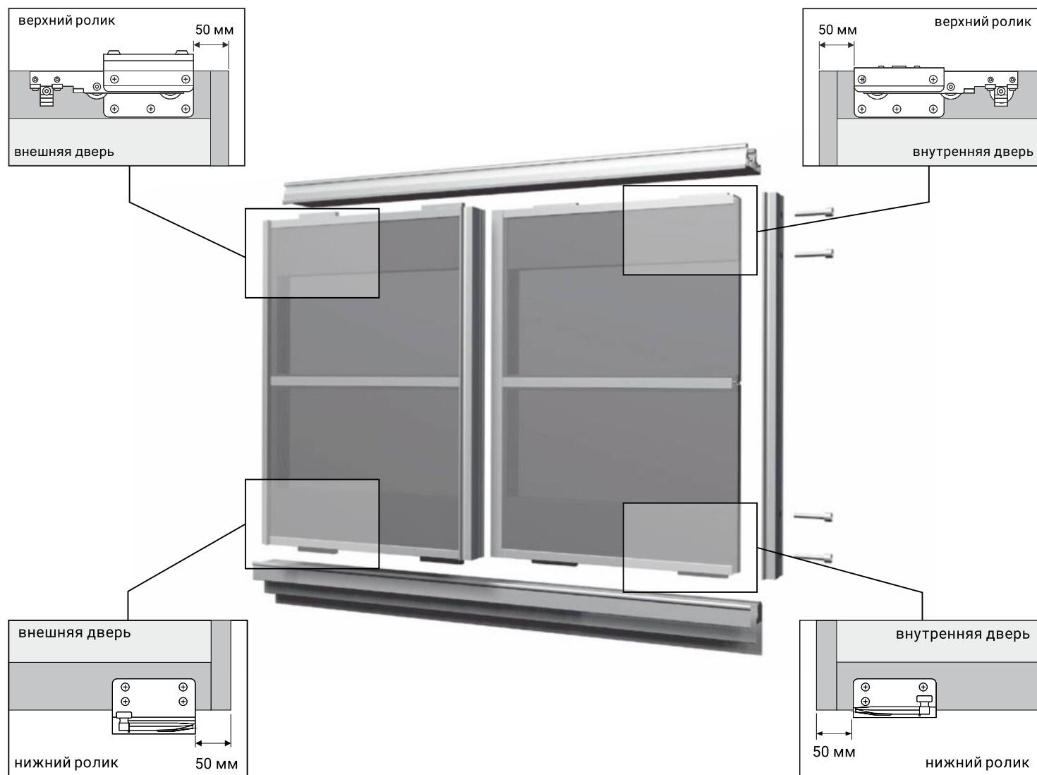
Схема расположения и расчет ширины фасадов относительно корпуса при использовании вертикальных профилей MS 161, 162, 163, 164.
