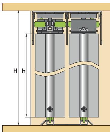
$$h \text{ (высота двери)} = H \text{ (высота проёма)} - 43 \text{ мм}$$
