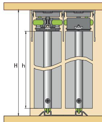
$$h \text{ (высота двери)} = H \text{ (высота проёма)} - 40 \text{ мм}$$
