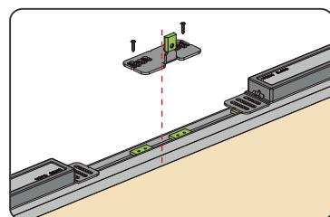
Установите позиционер передней двери в соответствии со схемой
