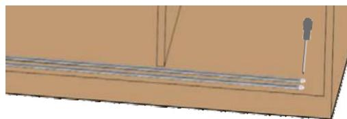
Закрутите винт в заглушке, чтобы вынуть направляющую
