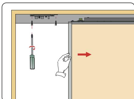
3 При необходимости отрегулируйте улавливатель задних дверей.
