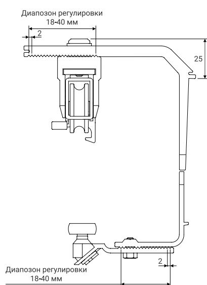
Схема для фасадов максимальной толщины
