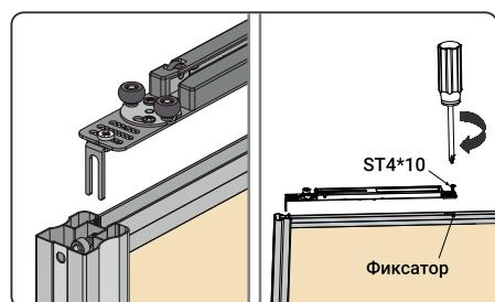
4 Регулировка положения распорных роликов
