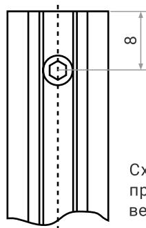
Схема присадки вертикальных профилей для крепления верхнего горизонтального профиля
