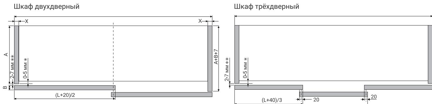
Схема установки роликов системы MODUS ORK на фасады из ДСП, МДФ, массива и т.д. толщиной от 18 до 40 мм.
