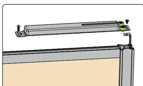
4 При использовании симметричного профиля придерживайтесь положения ноль при фиксации доводчика
