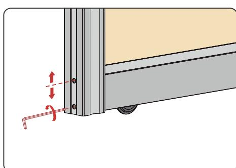
15 Схема регулировки улавливателей
