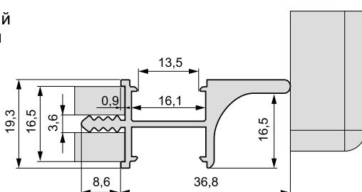
Профиль рассчитан на установку светодиодной ленты шириной 5-15 мм (на клейкой основе).
