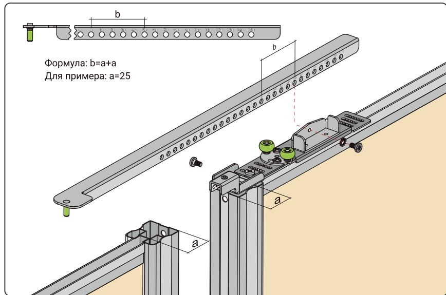
8 Регулировка нижних роликов по высоте
