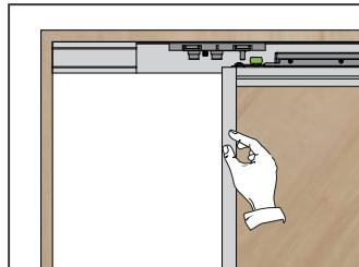
5.1. Закройте дверь в левую сторону. После срабатывания доводчика переместите дверь далее по ходу движения до нужного положения
