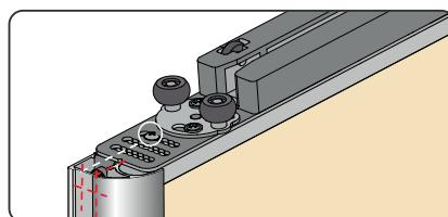
6 При использовании симметричного профиля придерживайтесь положения ноль при фиксации доводчика
