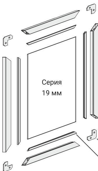
Схема присадки профилей 19 мм
