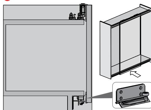
Вставьте ролик в направляющую и защелкните его, надавив на нижнюю часть двери
