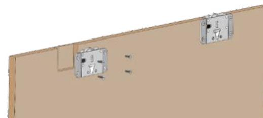
7.1. Зафиксируйте ролик в нижнем положении
