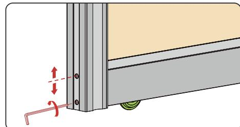
9 Установка улавливателя в направляющую
