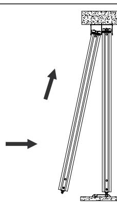
13 Толкните дверь. После срабатывания доводчика переместите дверь далее по ходу движения до нужного положения. Улавливатель автоматически установится
