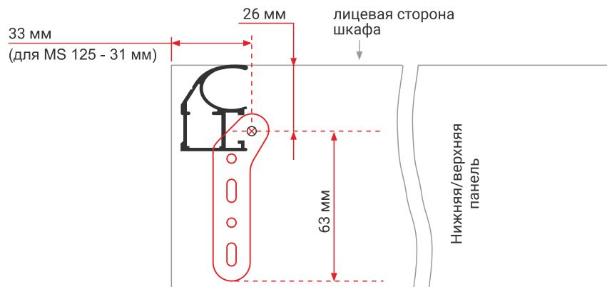
Расчет размеров распашных дверей для шкафов производится в соответствии с таблицей №3.
